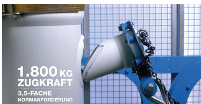
Prüfung am Beispiel POLO-ECO plus Premium DN 400/160/45°
