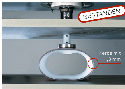
Punktlastprüfung mit seitlicher Einkerbung
