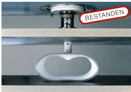
Durchstoßprüfung mit Spitzdorn
