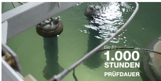
Unterschiedliche POLO-KAL® Rohre bei der Zeitstandinnendruckprüfung
